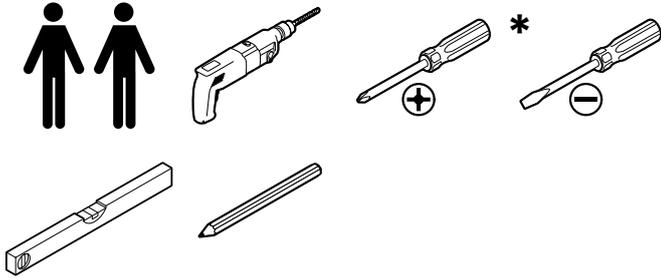
**\* VORSICHT:** Bei Verwendung eines Akkuschraubers (nicht empfohlen) möglichst niedrige Drehmomentstufe wählen!
